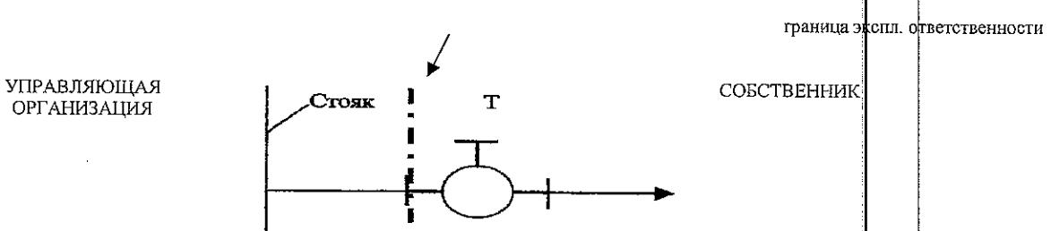
2. По системе водоотведения: точка присоединения отводящей трубы системы водоотведения квартиры к тройнику транзитного
